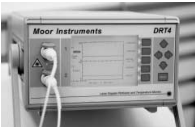
Abb. 1 Laser-Doppler-Gerät von Moor (Laser Doppler Monitor DRT4)
