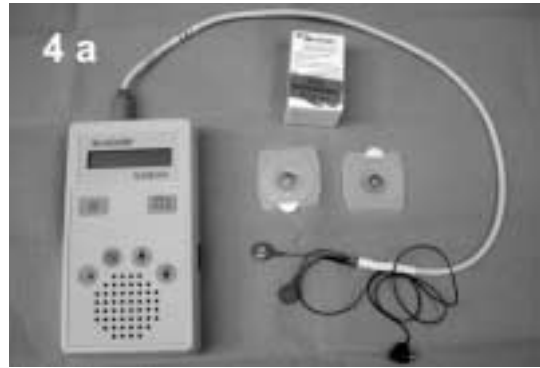
Abb. 4: EMG kontrollierte Blockade des Musculus pterygoideus lateralis mit Botulinumtoxin A, EMG-Gerät mit Elektroden und Teflonnadel zur Ableitung der EMG-Signale,
